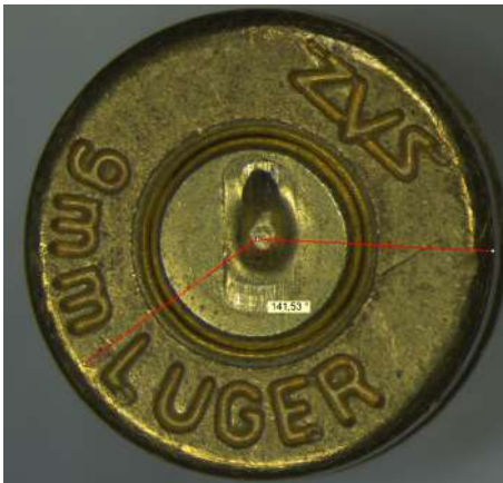
Рис. 16. Сліди на гільзах, стріляних в пістолеті «Glock-17» із зазначенням кута між центрами слідів виступу відбивача та зачепу викидача: а) 149,52°; б) 142,14°; в) 146,31°; г) 139,37°; р) 140,38°; д) 141,53°.
