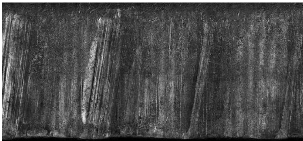
Рис. 17. Ведуча частина кулі патрона 9x19 мм, стріляної з пістолета «Glock 17».
