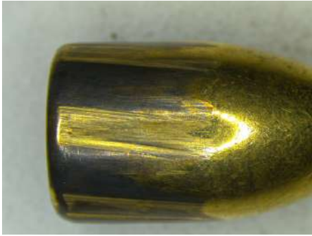
Рис. 18. Сліди на кулі, стріляної з пістолета «Glock-17» калібру 9х17 мм.
