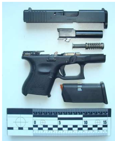
Рис. 4. Пістолет «Glock-26» у частково демонтованому стані.
