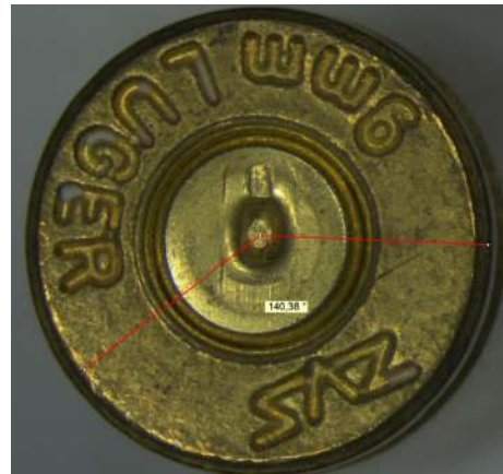
Рис. 16. Сліди на гільзах, стріляних в пістолеті «Glock-17» із зазначенням кута між центрами слідів виступу відбивача та зачепу викидача: а) 149,52°; б) 142,14°; в) 146,31°; г) 139,37°; р) 140,38°; д) 141,53°.
