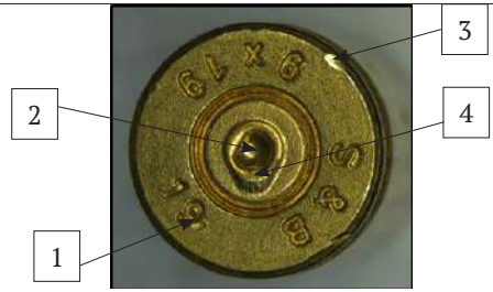
Рис. 12. Сліди на гільзі патрону, стріляного з пістолета «Glock-26» калібру 9x19 мм модифікації Gen 5: 1 – відбивача; 2 – бійка ударника; 3 – країв отвору в чашці затвору під бійок ударника зачепа викидача; 4 – зачепа викидача, 5 – слід ковзання нижнього краю каналу ударника.
